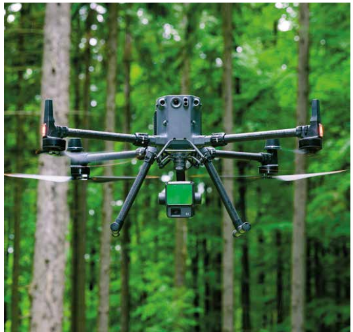
Laserscan-Drohne des Institut für Waldwachstum (DJI Matrice 350 RTK mit Laserscanner Zenmuse L2)
