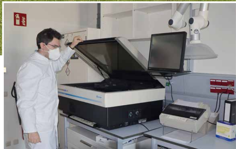
Berthillers Lieblingsgerät: Flüssigkeitsszintillationszähler aus dem Jahr 1994 zur Messung radioaktiver Strahlung. »Old but gold!« – lautet das Motto. Das Gerät wird regelmäßig zur Messung unlöslicher Metaboliten verwendet.
