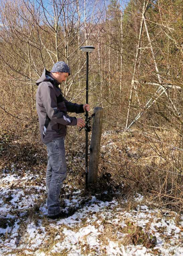
Martin Linkeseder beim Vermessen der Naturgrenze, um diese nach dem Neubau des Mastes wieder herstellen zu können.
