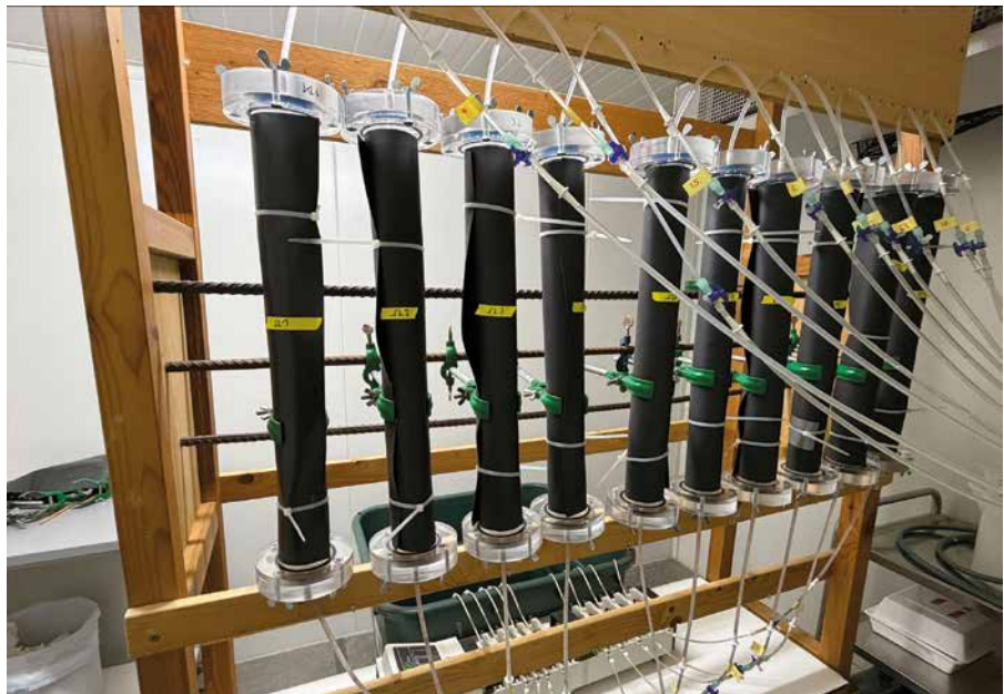
Durchflussreaktoren zur Testung der P-Adsorption von Pflanzenkohle und LECA Tonkugeln
